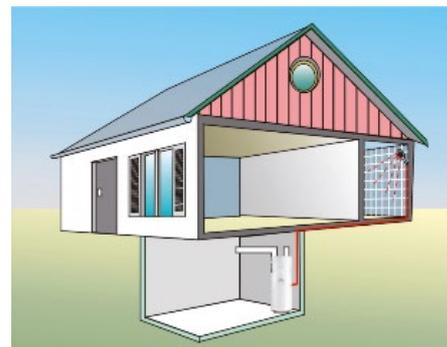
Die Wärmepumpe **Astral W** findet auch in kleinen Kellerräumen Platz und ersetzt einen konventionellen Warmwasserspeicher, der mit einem Kessel oder elektrisch beheizt wird.
