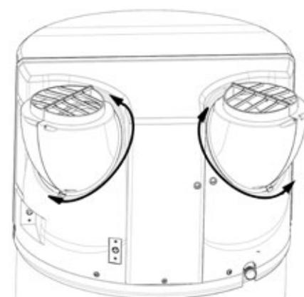
Drehbare Abluft- bzw. Ansaugkanäle können warme Luft ansaugen und kalte Luft ableiten, wo immer dies von Vorteil ist.
